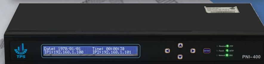
در نهایت می توان گفت تایم سرور صنعتی رک مونت راه حلی مطمئن و با عملکرد بالا برای همگام سازی زمانی کلاینت ها می باشد که دارای قابلیت های متعددی از جمله پشتیبانی از پروتکل های متفاوت، مانیتورینگ از طریق پروتکل SNMP، مانیتورینگ ماهواره و ... می باشد.
